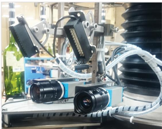
**KUBE OCS CONTROL CAMERA** sistema di controllo qualità applicazione a inseguimento interno giostra, con camera a autoapprendimento immagine
