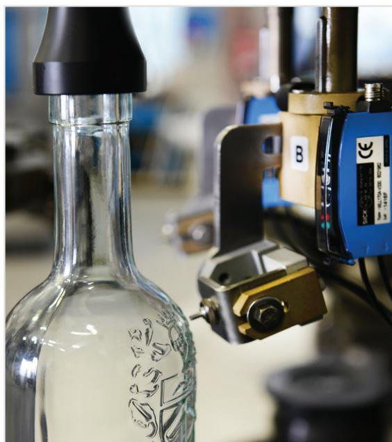
**KUBE OCS** sistema centraggio contenitore su ogni singolo piattello con fibra ottica
