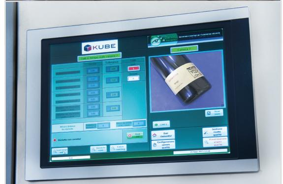
**KUBE OCS CONTROL CAMERA** sistema di controllo qualità applicazione con PLC dedicato per memorizzazione formati
