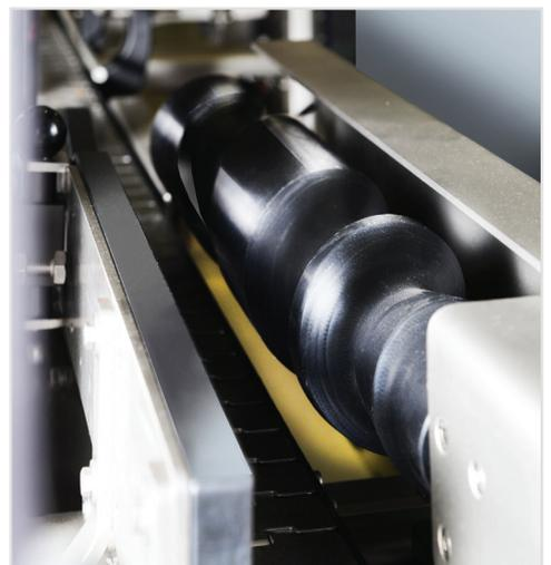
Coclea universale per contenitori cilindrici, variazione 40-70 mm e 70-110 mm
