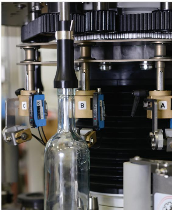
**KUBE OCS** sistema centraggio contenitore a inseguimento interno giostra con fibra ottica
