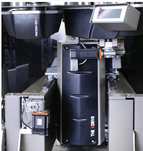
Stazioni etichettaggio robotizzate, assi di regolazione automatici
